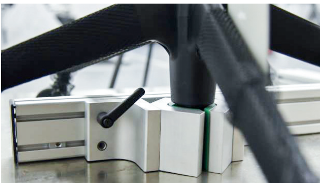
Prisma für Prüfobjektfixierung | Prism for test object fixation
